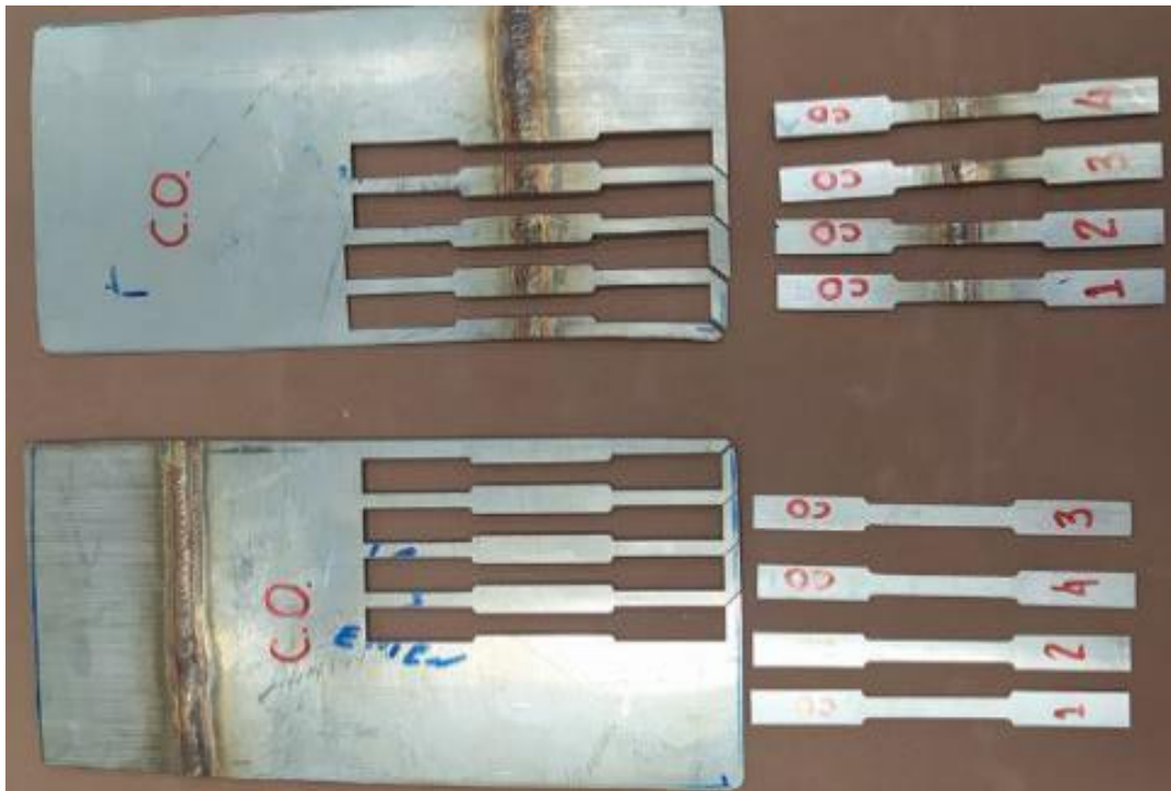
Figura 21 - Foto digital dos corpos de prova entre o corpo cilíndrico do tanque de armazenamento de água aquecida (boiler) e o tampo, e da junta entre a solda e o metal de base COM sobreposição (“overlap”).
