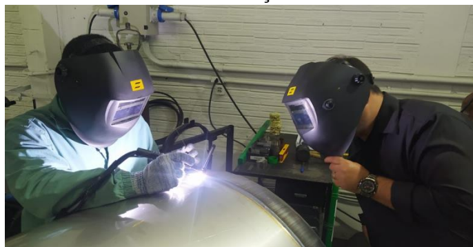
Figura 12 – Foto da visita técnica para entendimento do processo atual da linha de produção de reservatórios de aço inox AISI 304.
