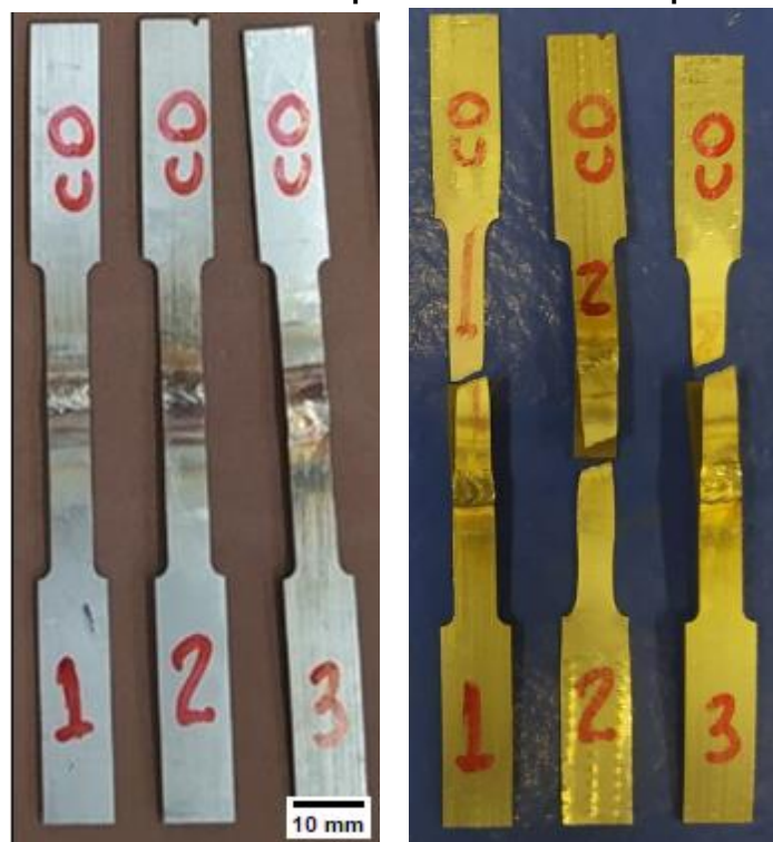
Figura 39 - Amostra com overlap antes do ensaio e depois do ensaio.
