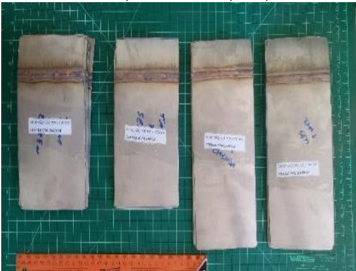
Figura 15 - Amostras cordão de solda COM e SEM Overlap de partes da junção do tanque cilíndrico de aço inox AISI 304 com o tampo estampado.
