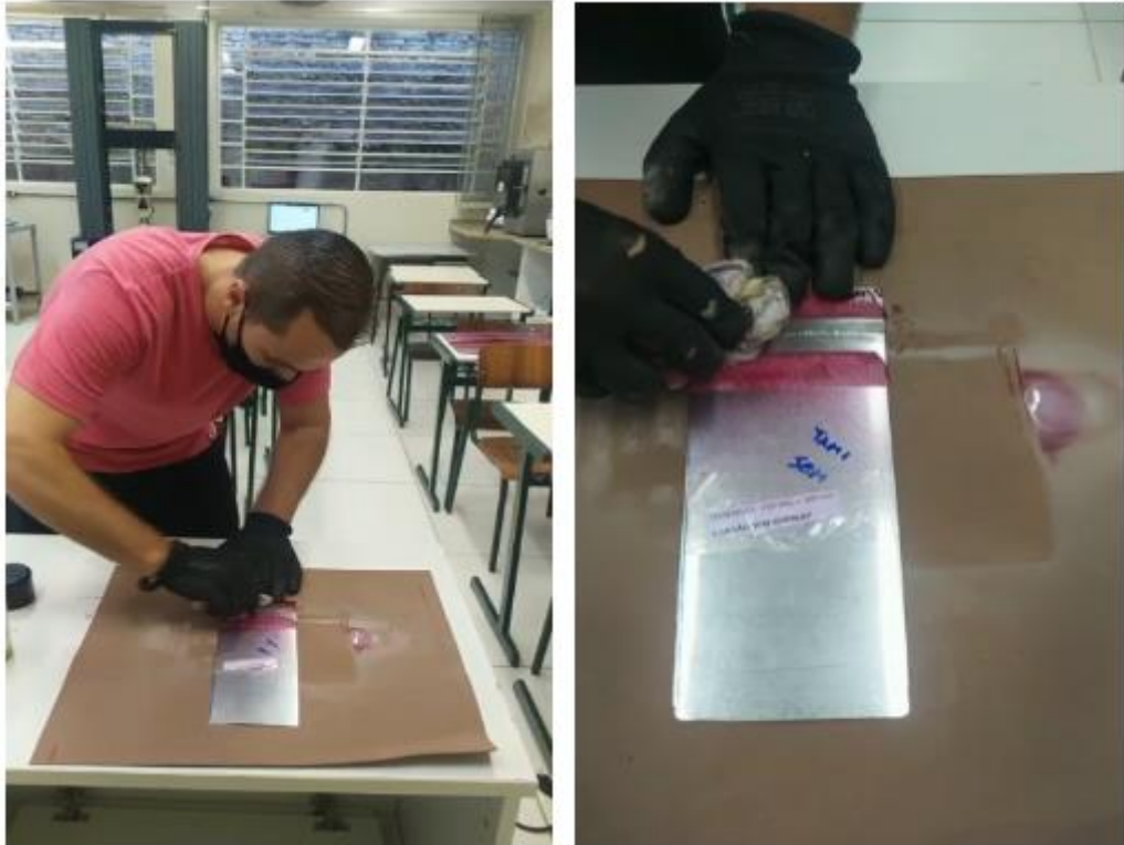
Figura 26 - Remoção do excesso LP
