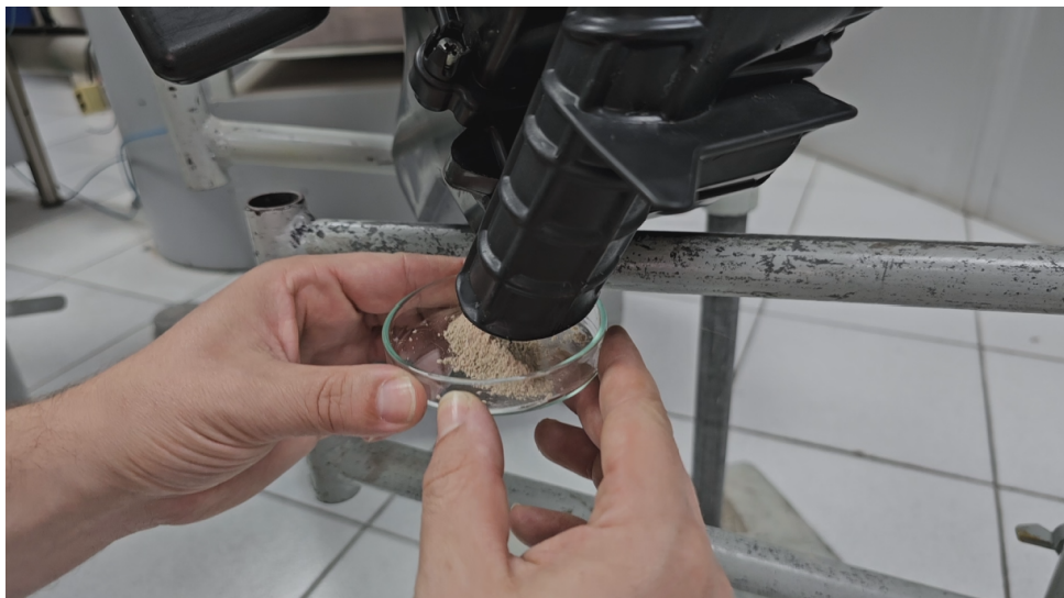
Figura 3.4 – Ilustração do sistema utilizado para a dosagem de poeira no filtro.
