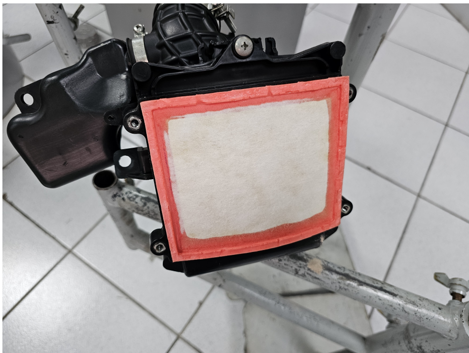
Figura 3.3 – Montagem do elemento filtrante reto para o teste de \Delta P x Vazão.
