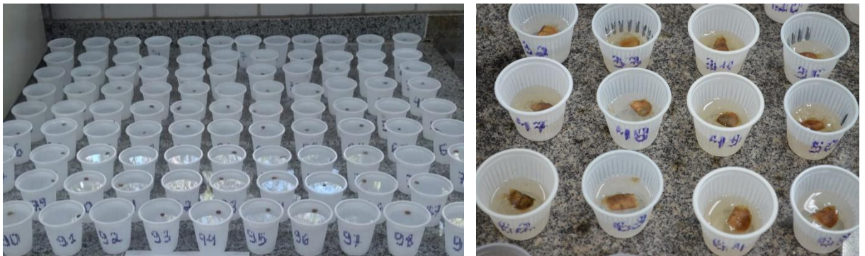
Figura 2. Teste de condutividade elétrica pelo método individual.
