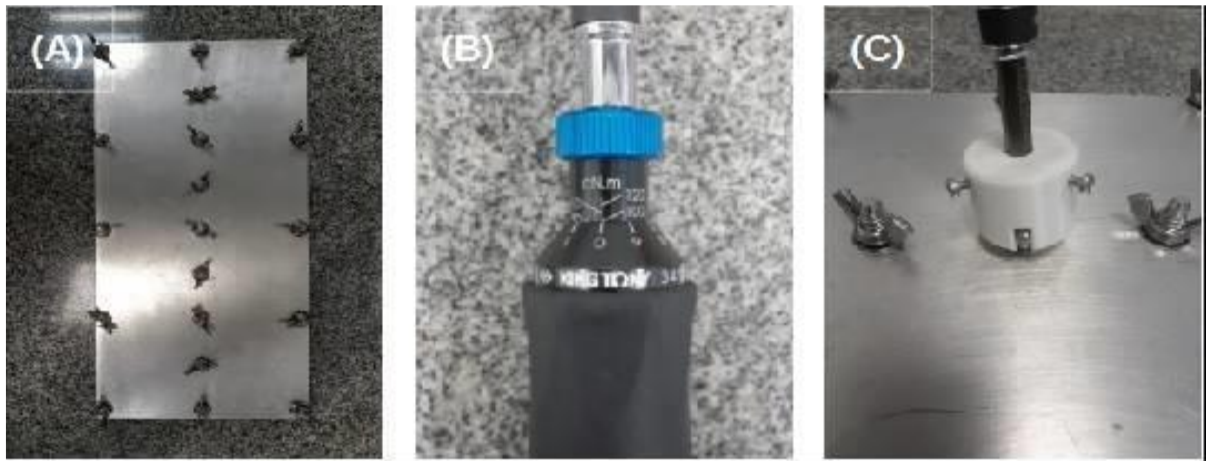
FIGURA 3.6: Sequência de fechamento das porcas borboletas para a etapa de congelamento. (A) Suporte com as porcas borboletas posicionadas; (B) torquímetro regulado e (C) Fechamento das porcas borboletas.
