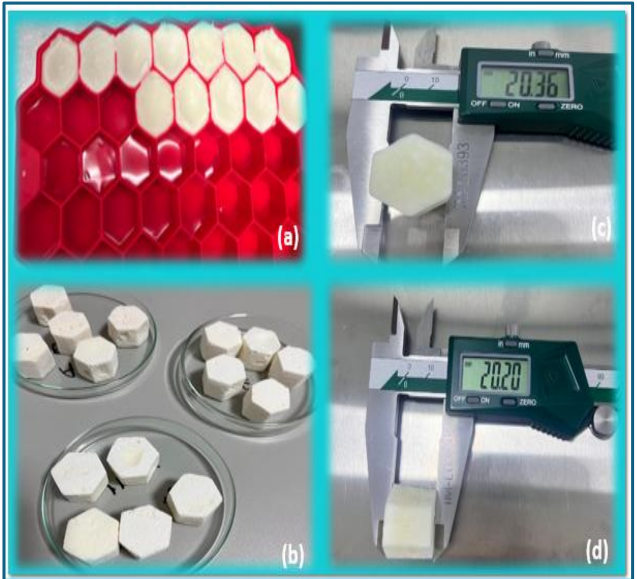
FIGURA 3.8: a) Forma de silicone hexagonal usada para conformação dos corpos de prova, b) amostra de mistura de colágeno e gelatina, c) e d) tomadas de medida das amostras.
