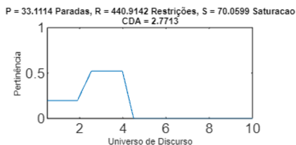
Figura 15 – Agregação das Regras para P = 33,1 R = 441 e S = 70% de saturação.
