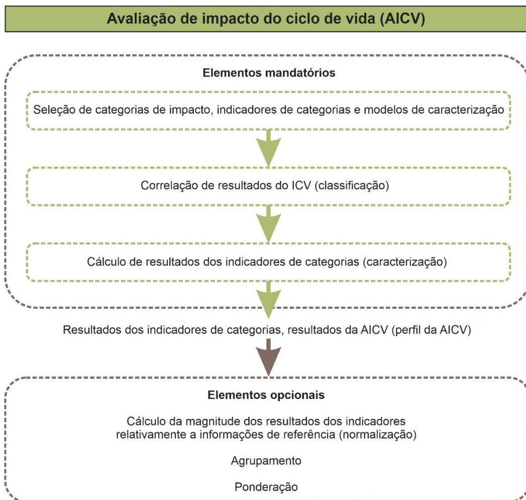
Figura 8 - Elementos da fase de AICV.
