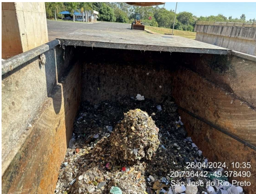
Figura 29 - Resíduos do gradeamento grosso depositado em caçamba e destinado para aterro sanitário.
