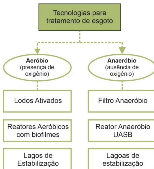
Figura 2 - Esquema sobre as tecnologias de tratamento de esgoto.
