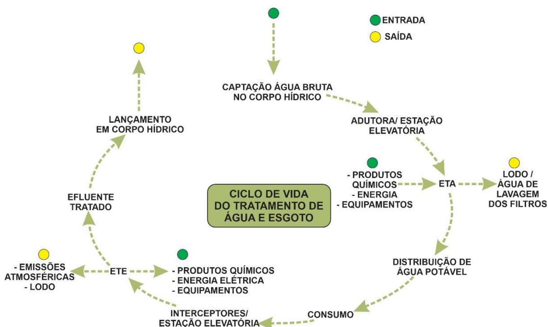
Figura 7 - Ciclo de vida do sistema de tratamento de água e esgoto.
