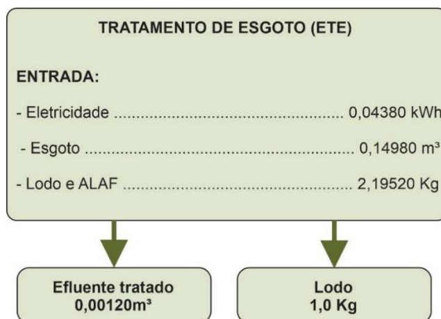
Figura 39 - Entradas e saídas do Processo 2 - Tratamento de esgoto modelado no software OpenLCA.
