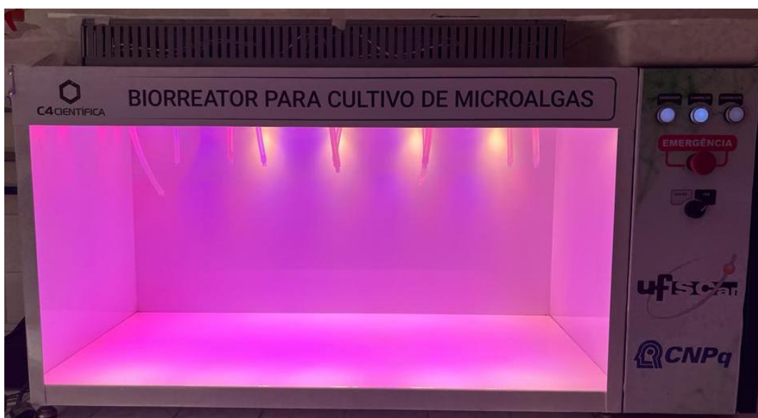
Figura 3. Fotobiorreator C4 Científica para tratamento de efluentes e cultivo de microalgas. Foto do autor.
