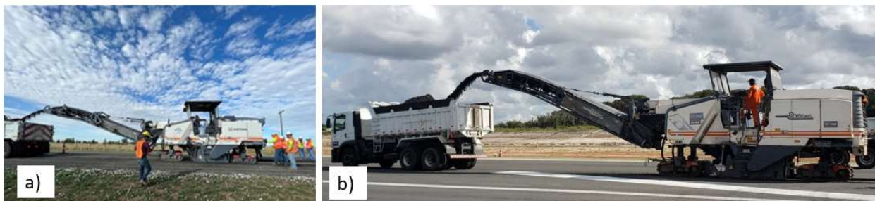
Figura 2.23 - Fresadoras Wirtgem modelo W200: (a) Estudos de Saxena et al (2023); b) modelo típico Wirtgem W200. Fontes: Elaborado pelo autor (2024).
