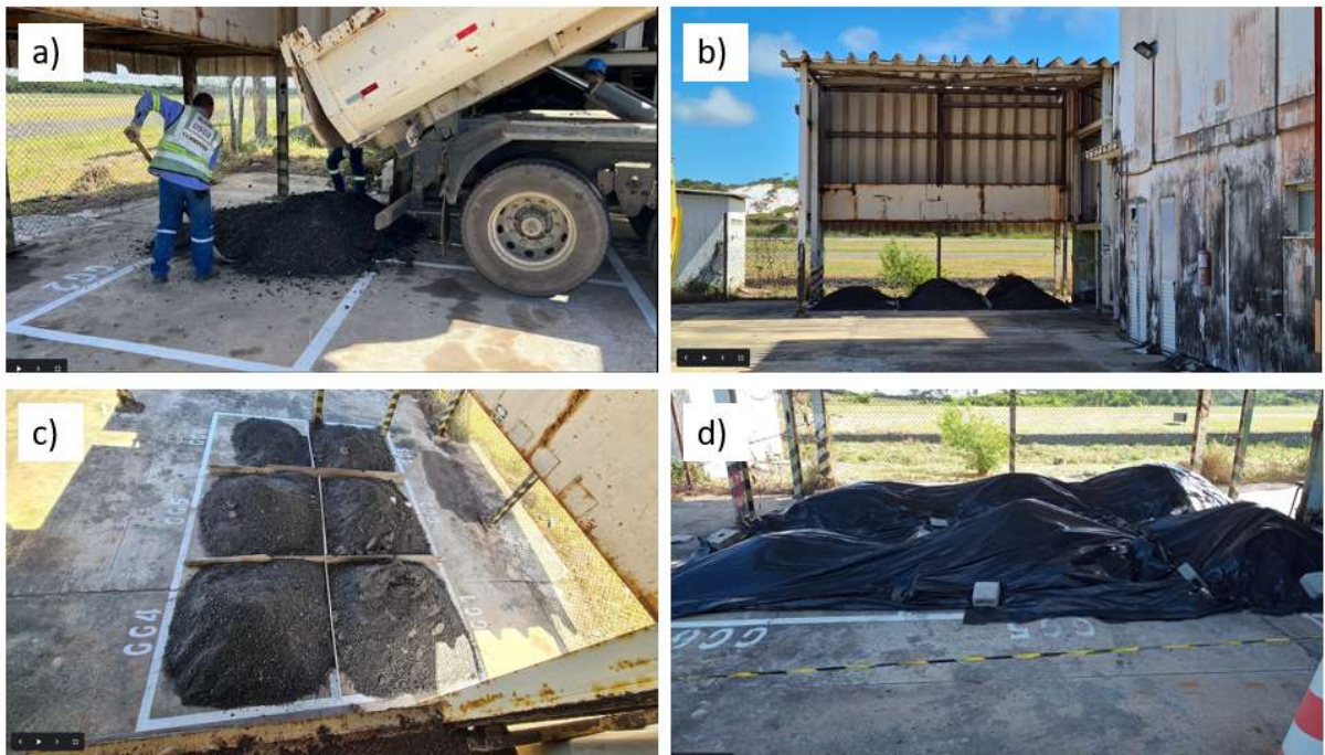
Figura 3.24 - Estocagem dos RAP-C e G-RAPs no Aeroporto: a) Processo de descarga; b) Vista da cobertura do estoque; c) Vista superior das pilhas de RAP; d) amostras cobertas para impedir ação das intempéries. Fonte: Elaborado pelo autor (2024).
