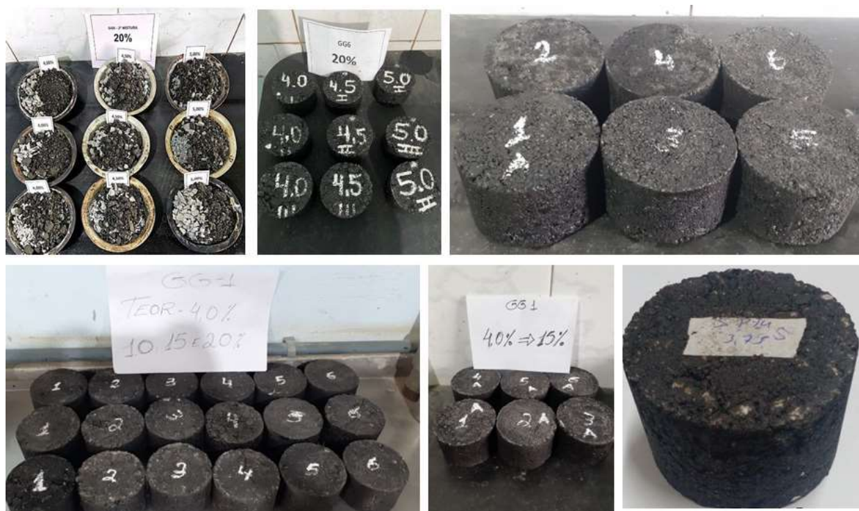
Figura 3.29 - Preparação dos corpos-de-prova em testes iniciais com RAP e o aspecto de um dos corpos-de-prova moldados com adição de G-RAP. Fonte elaborado pelo autor (2024).
