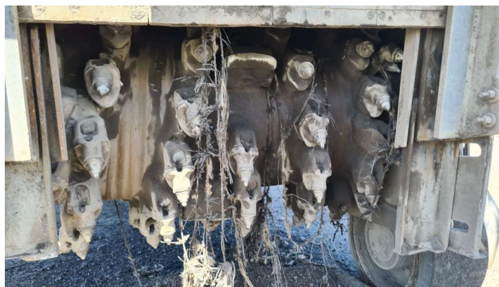
Figura 4.7 - Filamentos de geogrelha de poliéster enroscados no tambor de fresagem. Fonte: Elaborado pelo autor (2024).
