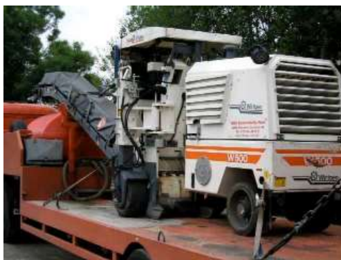
Figura 2.11 - Fresadora Wirtgem W500 utilizada no processo de fresagem. Fonte: Huesker (2022).
