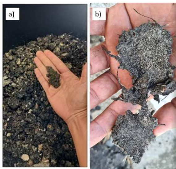
Figura 4.14 - Fragmentos de geotêxtil nos G-RAPs: a) Geotêxtil não tecido em amostra de Saxena et al. (2023) e b) G-RAP 3 oriundos desta pesquisa. Fonte: Elaborado pelo autor (2024).
