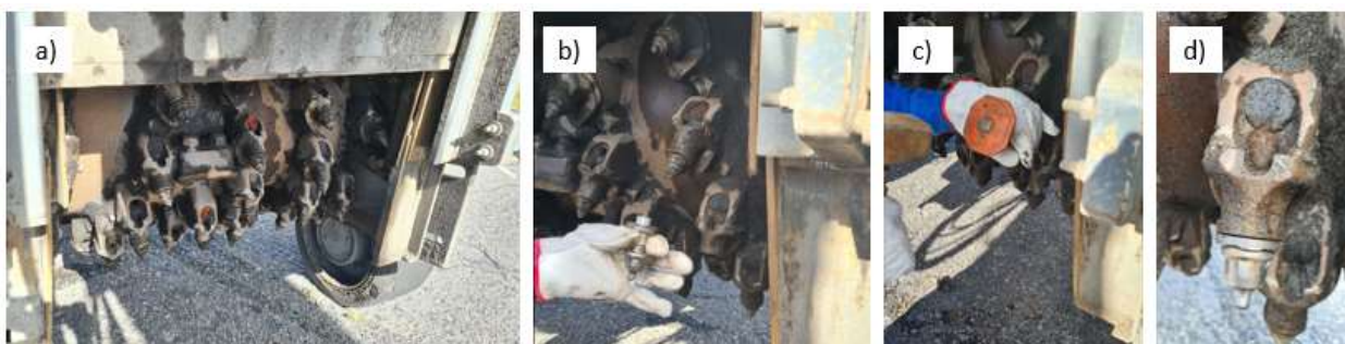
Figura 3.20 - Detalhes da fresadora W100: a) Aspectos do tambor de fresagem; b) Detalhe entre ponta de corte nova e desgasta; c) processo de substituição das pontas de corte; d) detalhe da nova ponta de corte.
