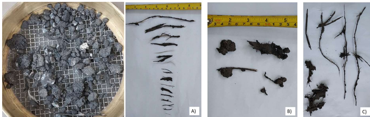
Figura 4.21 - Fragmentos de geossintéticos coletados G-RAP 4: a) Fibras entre 15 cm e 1 cm; b) Pedacos de fibras e geotêxtis; c) Fibras de até 25 cm e pedaços de geotêxtis. Fonte: Elaborado pelo autor (2024).
