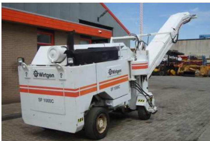
Figura 2.2 - Fresadora Wirtgen SF100 equivalente a utilizada nos estudos de Damisch e Kirschner (1994). Fonte: https://www.lectura-specs.com .
