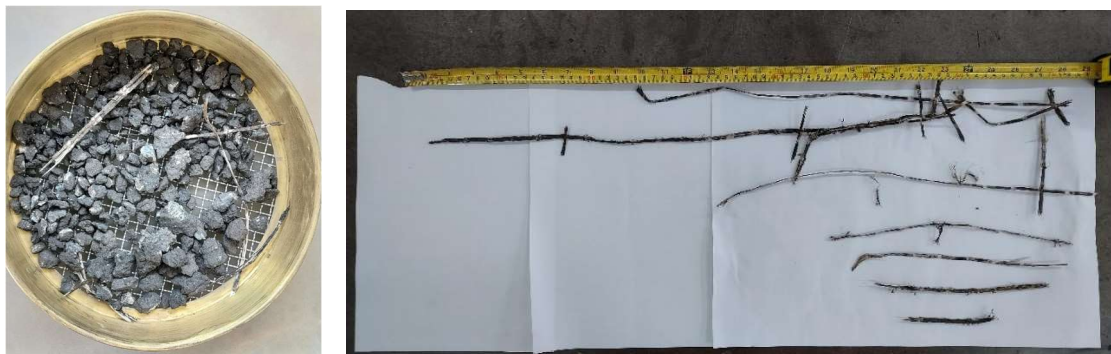
Figura 4.18 - Fragmentos de geossintéticos coletados no G-RAP 1. Fonte: Elaborado pelo autor (2024).
