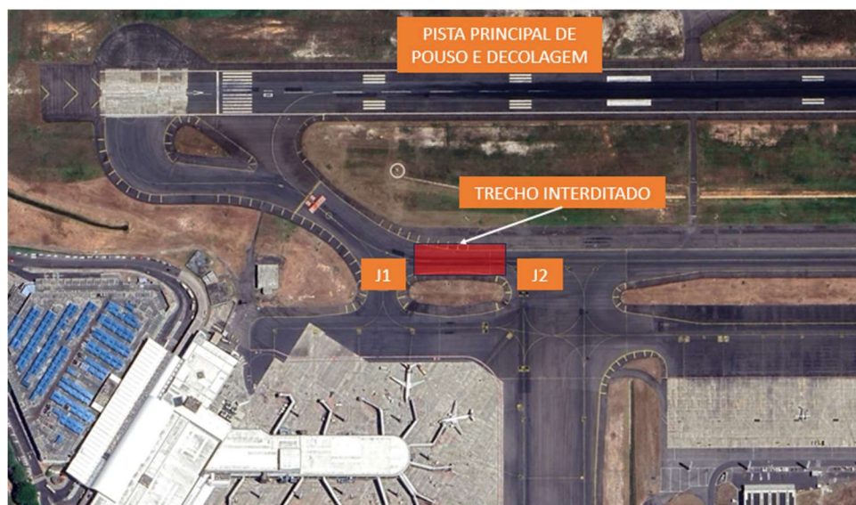
Figura 3.1 - Localização da Pista de Rolamento A interditada devido a patologias no pavimento.
