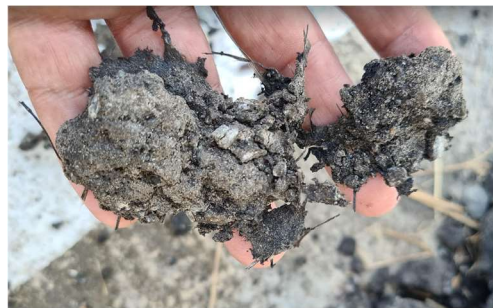
Figura 3.26 - Fragmento de geossintético fresado com presença de material britado. Fonte: Elaborado pelo autor (2024).
