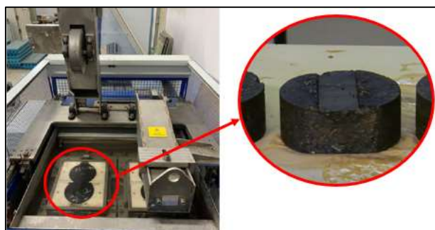
Figura 2.16 - Corpos-de-prova submetidos ao ensaio de Hamburg wheel-tracking test. Fonte: Wang and Huang (2020).
