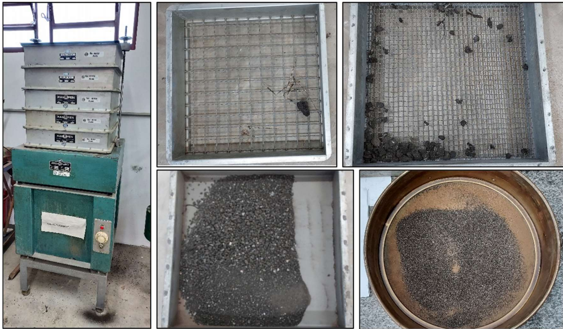
Figura 3.25 - Ensaio de peneiramento realizado para a determinação da granulometria nos G-RAPs e RAP-C. Fonte: Elaborado pelo autor (2024).
