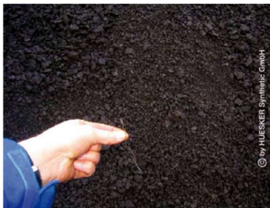
Figura 2.6 - Filamentos de geossintéticos presentes no G-RAP oriundo da fresagem. Fonte: Huesker (2008).
