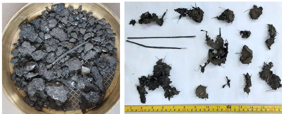
Figura 4.20 - Fragmentos de geossintéticos coletados G-RAP 3. Fonte: Elaborado pelo autor (2024)
