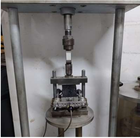
Figura 3.34 - Corpo-de-prova de mistura reciclada com G-RAP instalado no equipamento de medição do módulo de resiliência. Fonte: Elaborado pelo autor (2024).
