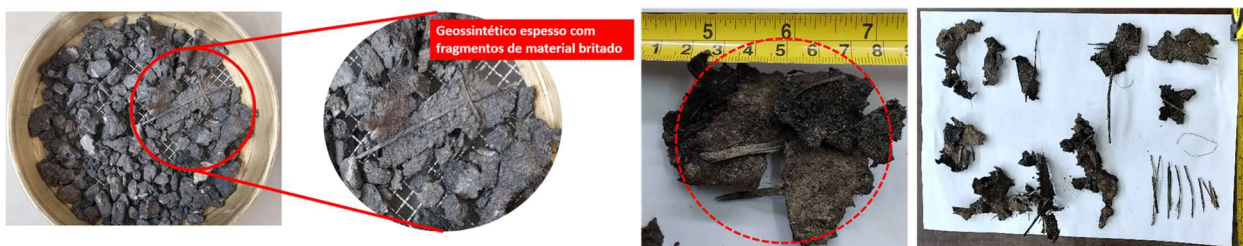
Figura 4.19 - Fragmentos de geossintéticos coletados no G-RAP2. Fonte: Elaborado pelo autor (2024).
