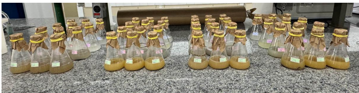
Figura 2.5 Erlenmeyers contendo meio NBRIP, diferentes fontes de fósforo e diferentes culturas bacterianas após 10 dias de incubação. Registrado pelo autor.
