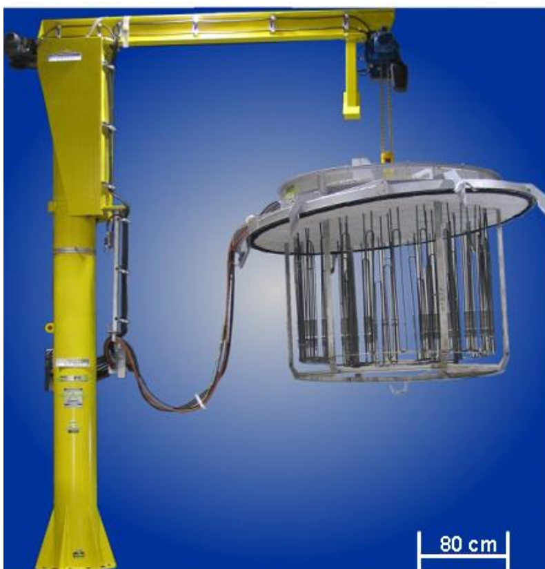
Figura 6.21 Ilustração de uma tampa antes de colocar sobre um cadinho
