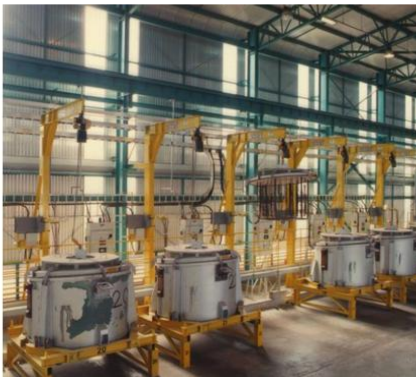
Figura 6.22 Ilustração de várias tampas resistentes instaladas sobre cadinhos
