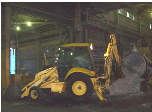
Figura 6.4, Detalhe da retroescavadeira efetuando limpeza de cadinho
