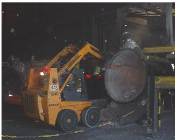
Figura 6.3 Detalhe da uniloader realizando limpeza de cadinho
