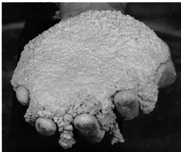
Figura 6.11 Concreto com água em excesso [27]
