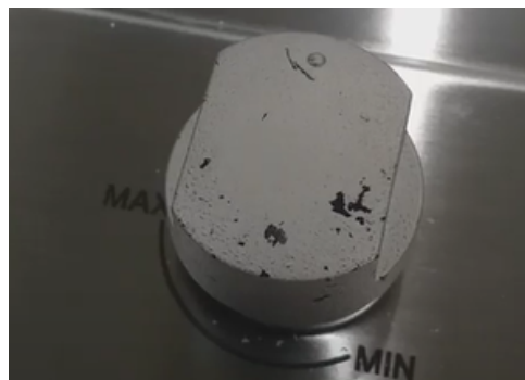
(b) Descascamento da tinta que recobre a peça plástica.
