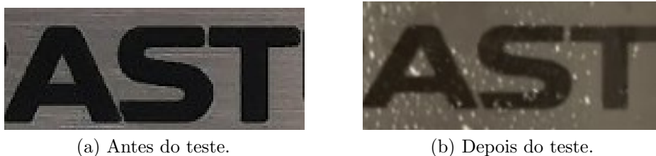
Figura 16 – Resultado do teste de spray salino para o logo serigrafado.
