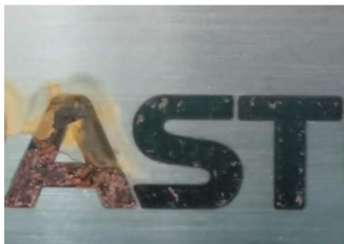
(a) Logo da marca com sinais de oxidação.
