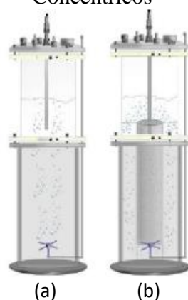
Figura 1 - Biorreatores Pneumáticos: (a) Coluna de Bolhas, (b) Airlift de Cilindros Concêntricos
