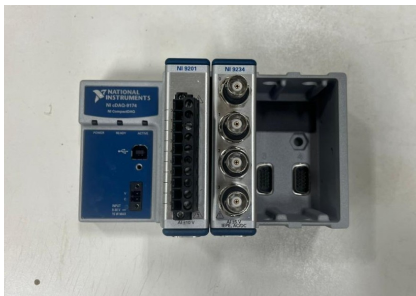
Figura 22 – Sistema de aquisição de dados modular NI CompactDAQ (cDAQ-9174) com módulos NI 9201 e NI 9234
