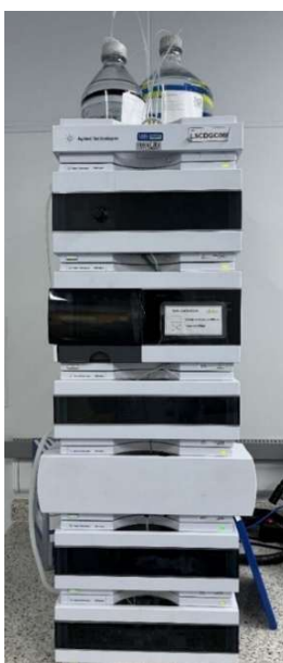
FIGURA 3- - Cromatógrafo líquido de alta eficiência - Agilent 1260 HPLC system
