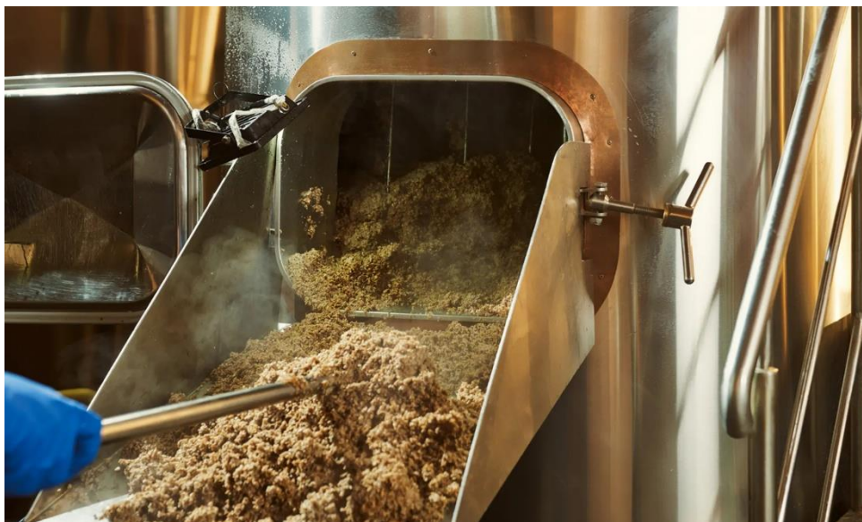
Figura 16 - Imagem de um biorreator para fermentação em estado sólido em larga escala
