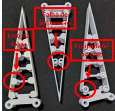
Figura 3.3 – Defeitos nas peças impressas
