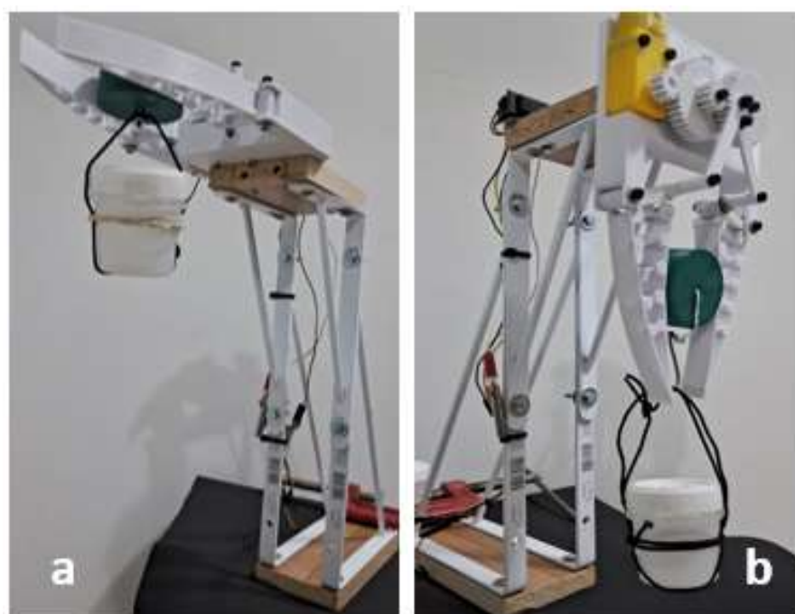
Figura 3.16 - Processo de acoplar massa no objeto nos sentidos: a) horizontal e b) vertical.
