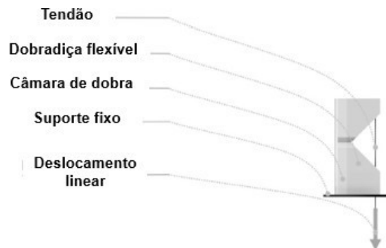
Figura 2.18 - Mecanismo de tendão
