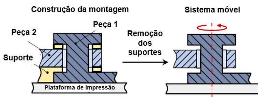
Figura 2.3. Manufatura aditiva de um mecanismo sem montagem
