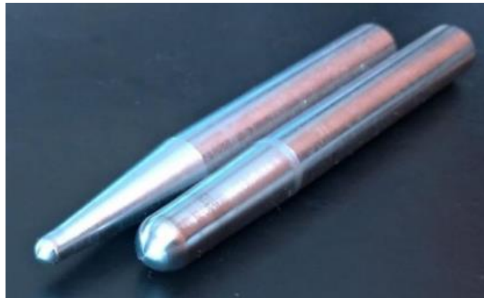
Figura 5 - Exemplo de ferramenta semiesférica utilizada no processo de estampagem incremental.
