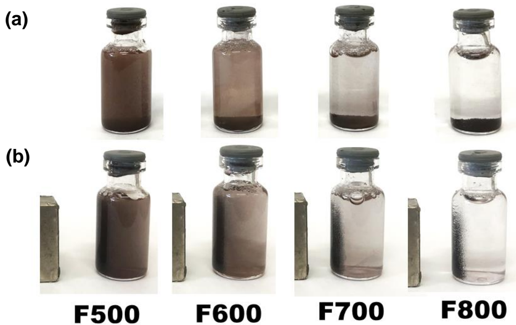
FIGURA 4.29. Amostras de ferrita de cobre em meio aquoso: (a) sem campo magnético e (b) com aproximação de um campo magnético.
