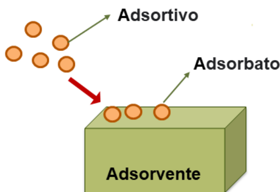
FIGURA 1.2. Esquema do processo de adsorção na superfície de um adsorvente. Fonte: Próprio autor.
