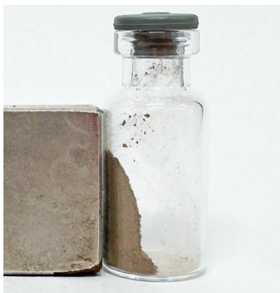
Figura 4.34. Ilustração do nanocompósito magnético Z18 M:F500 com aproximação de um campo magnético externo.
