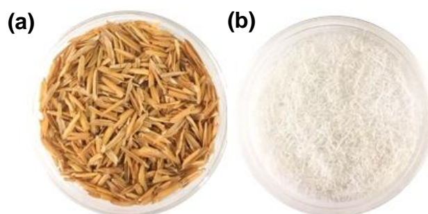
FIGURA 4.13. Casca de arroz (a) antes do tratamento térmico e (b) após tratamento térmico ( \text{SiO}_2 ).
