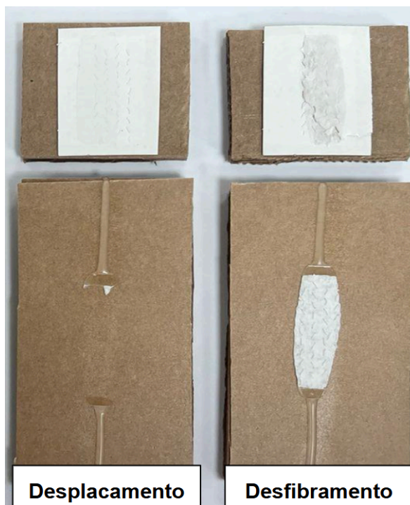
Figura 25. Resultados de desfibramento em análises de força de adesão.
