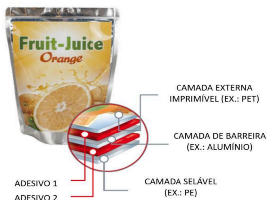
Figura 10. Ilustração de um Stand Up Pouch trilaminado com especificações das camadas poliméricas.
