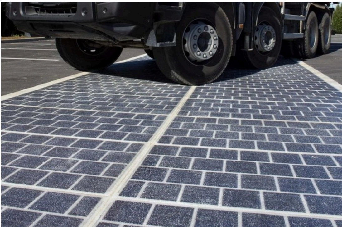
Figura 8- Painéis Solares em Teste para o Projeto Solar Roadways .
