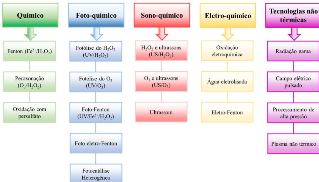
Figura 4 - Classificação dos processos oxidativos avançados segundo a técnica utilizada para gerar os radicais oxidantes.
