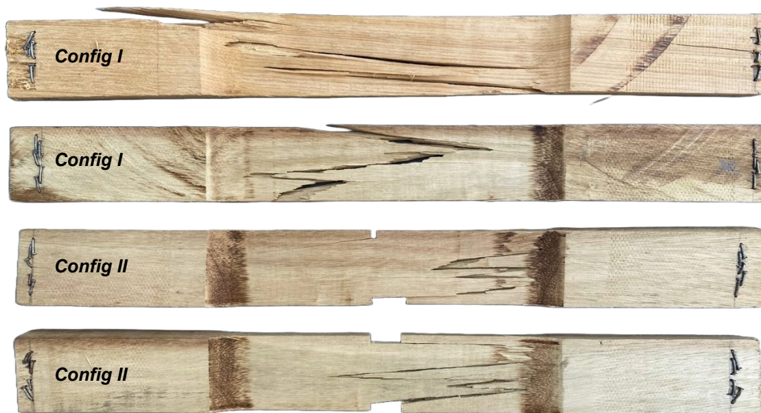
Figura 55 – Padrões de ruptura em duas configurações para a Tatajuba
