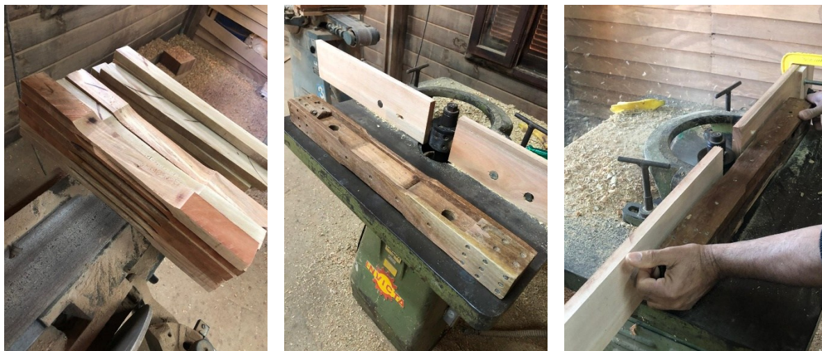
Figura 25 – Confeccção dos Corpos de prova de tração paralela às fibras
