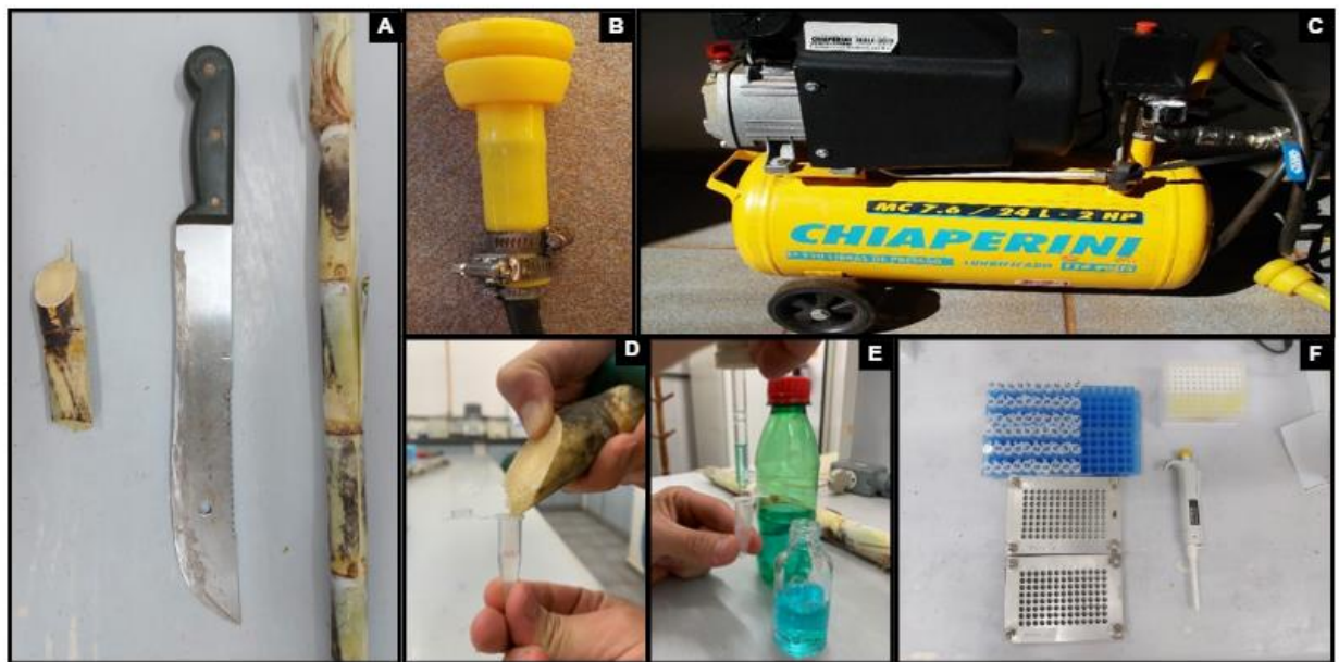
Figura 1 - Processo de análise sorológica para detecção de Xanthomonas albilineans em seiva de cana-de-açúcar. (A) Corte e coleta do material vegetal; (B) Adaptação de "teteira" de silicone (3 cm de diâmetro) acoplada ao compressor para extração de seiva; (C) Compressor utilizado para extração por pressão positiva; (D) Extração de seiva de internódios individuais; (E) Adição de conservante (Cloreto de Aquil Dimetil Benzil Amônio); (F) Execução do exame sorológico dot blot .
