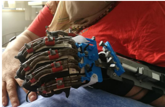
Figura 25 – Exoesqueleto com tracionamento por fios e ancorado em uma luva de tecido
