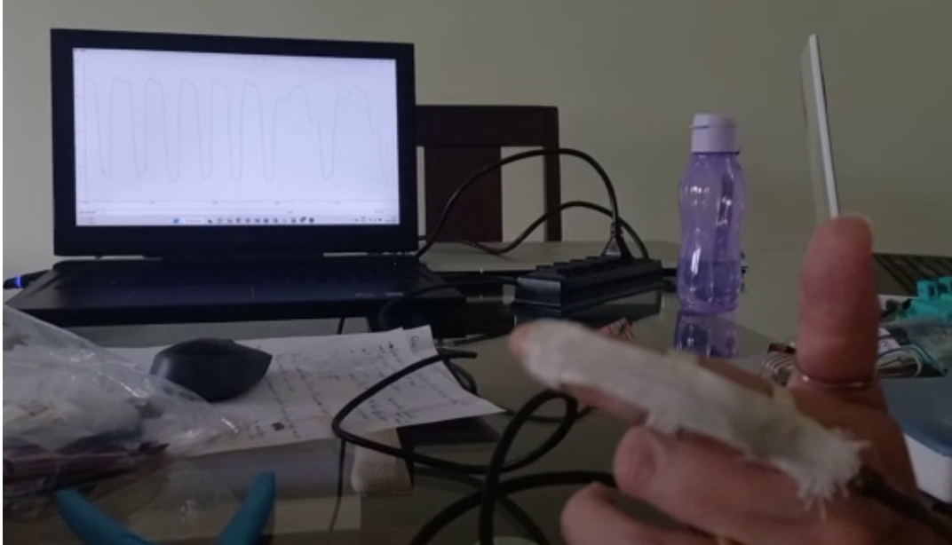
Figura 40 – Comportamento dos dados coletados a partir da deformação do sensor flex
