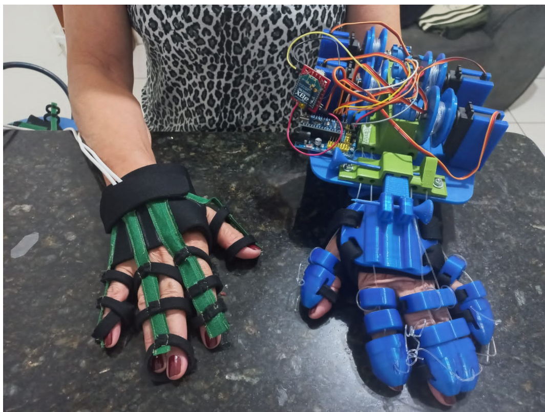
Figura 53 – Protótipo com servos de rotação contínua e potenciômetros multivoltas
