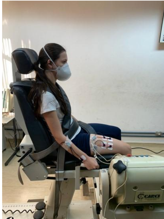
Figura 12- Posicionamento do participante na cadeira do dinamômetro e posição dos eletrodos da EMG
