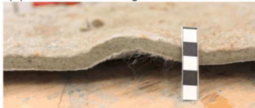
Figura 2.16 - A bentonita distribuída uniformemente em locais próximos aos pontos de contato das partículas de cascalho em (a) ensaio NWSR-2 e (b) ensaio NWSR-4 após aplicação de carga hidráulica (Fan e Rowe, 2023).
