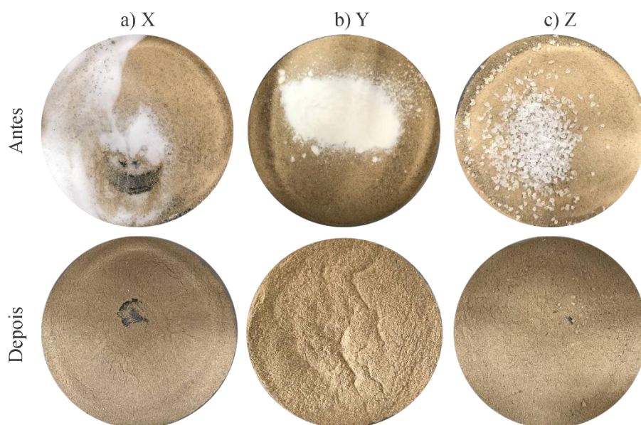
Figura 3.5 - Preparação das misturas de CaB ativada com sódio e polímeros antes e depois da homogeneização: (a) X, (b) Y e (c) Z (Próprio Autor, 2025)
