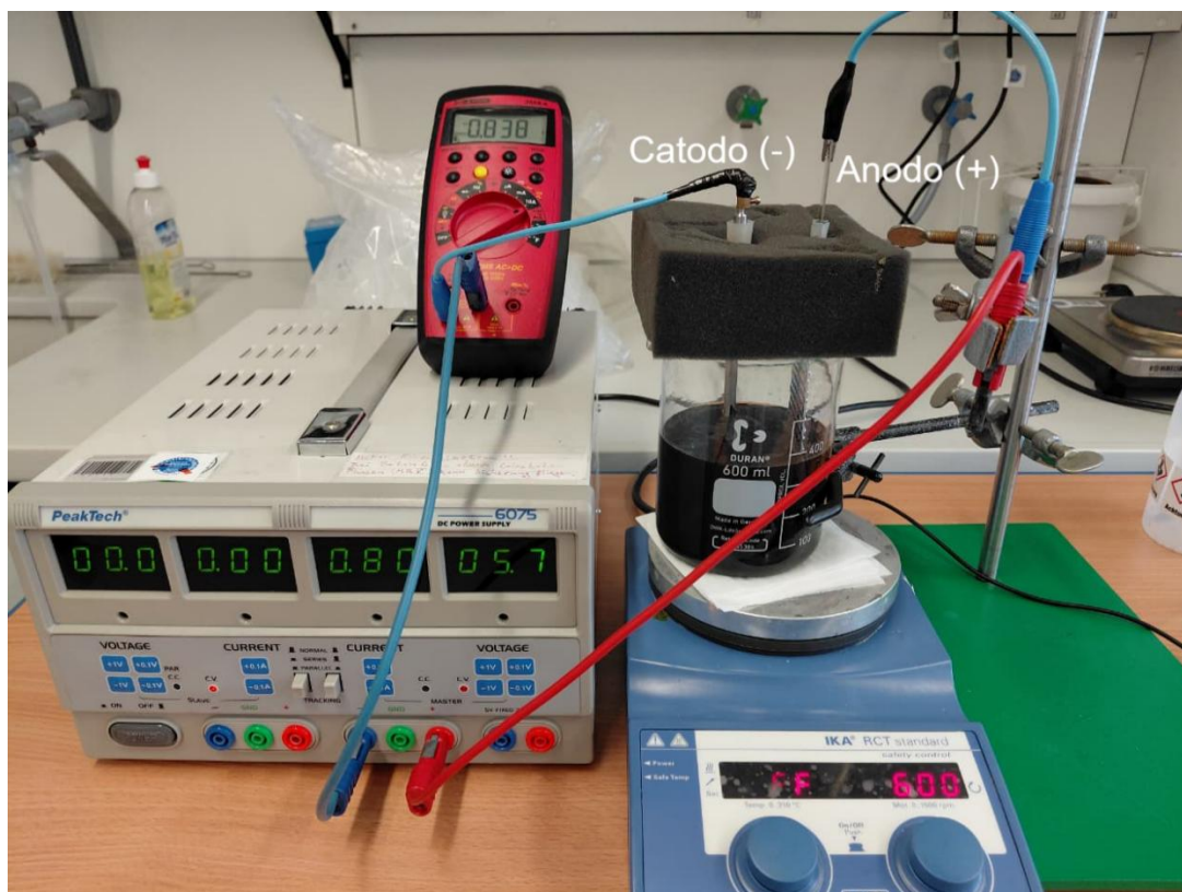
FIGURA 2.3 – Fotografia do sistema experimental utilizado para a eletrodeposição da liga NiCoP em substrato de papel de carbono com área de 5 cm 2 . Fonte: Próprio autor.
