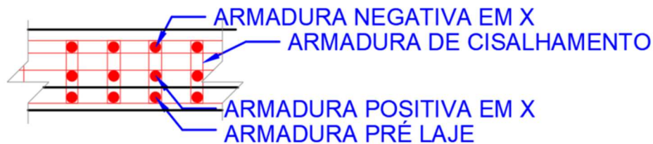
Figura 21 - Corte genérico em y com as armaduras
