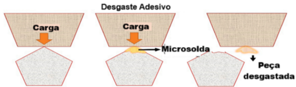
Figura 7 - Representação esquemática do desgaste adesivo
