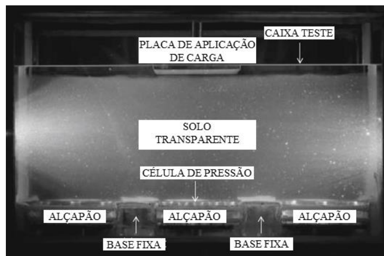
Figura 2.27. Ensaio de alçapão com solo transparente
