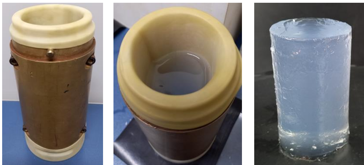
Figura 3.6. Confeção dos corpos de prova de argila transparente: (a) Molde cilíndrico, (b) Molde preenchido com a argila transparente, (c) Corpo de prova desmoldado
