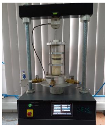
Figura 3.7. Equipamento utilizado no ensaio triaxial: (a) câmara, (b) prensa
