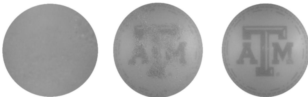
Figura 2.24. Transparência da argila sintética com concentrações de PSD de: (a) 0,70%, (b) 0,96%, (c) 1,5%
