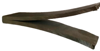
Figura 20 - Amostra fraturada após laminação criogênica superior a 30%.
