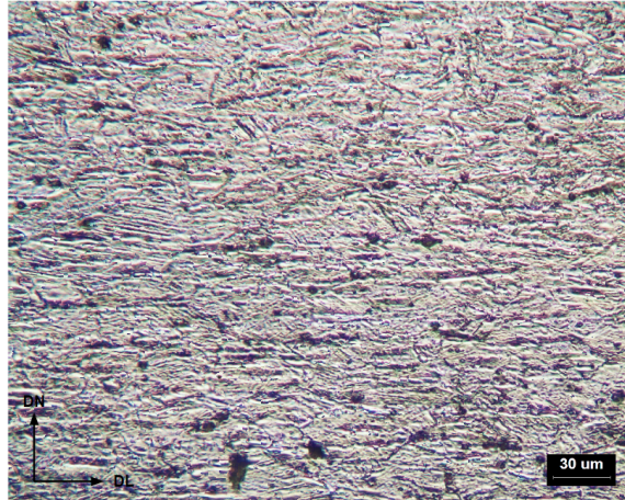
Figura 19 - Microestruturas do AIA 201LN na condição (a) CR, (b) CS, (c) LCS10, (d) LCS20, (e) LCS30. Ataque eletrolítico em ácido oxálico.
