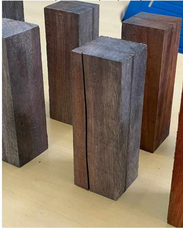
Figura 22 - Rachadura na superfície de corpo de prova após 8 meses de exposição
