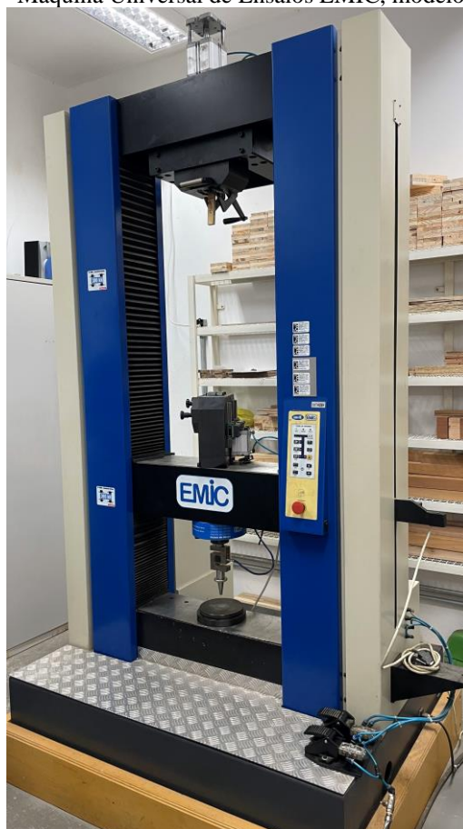
Figura 9 - Máquina Universal de Ensaio EMIC, modelo DL30000
