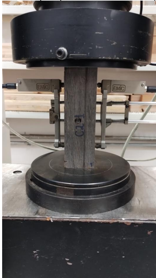
Figura 10 - Corpo de prova com extensômetro acoplado
