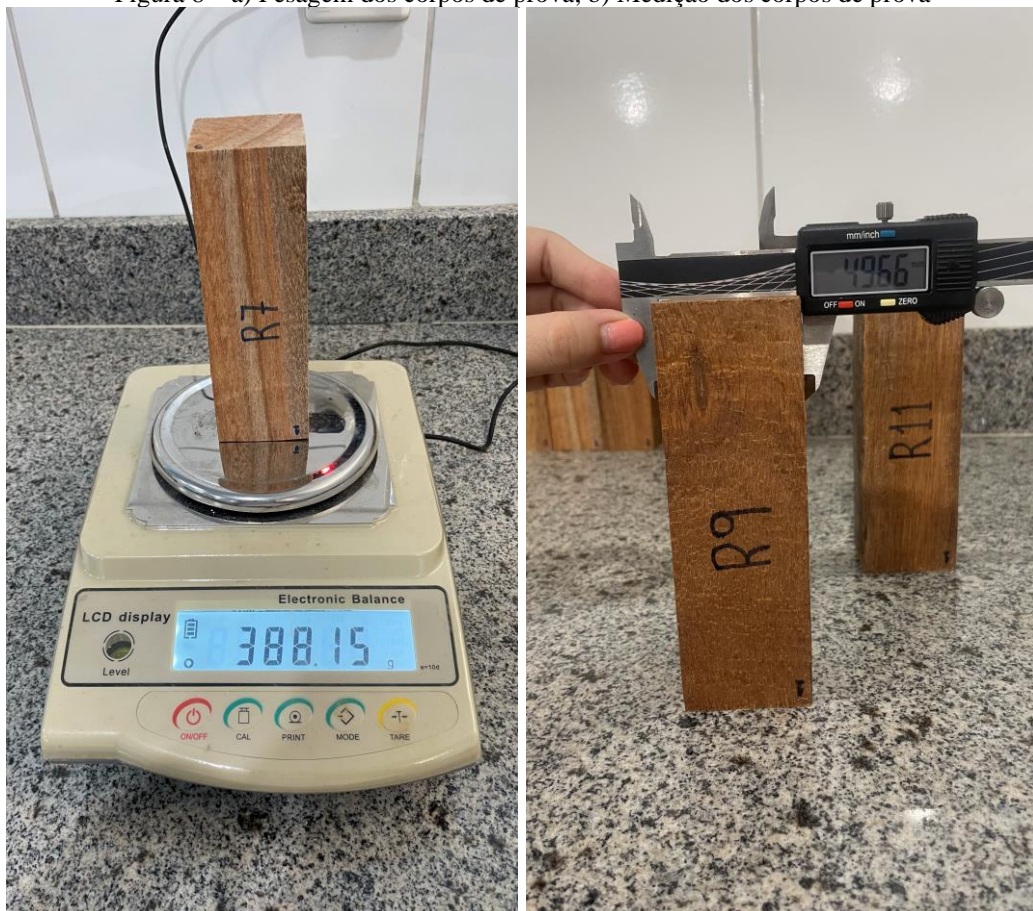
Figura 8 – a) Pesagem dos corpos de prova; b) Medição dos corpos de prova
