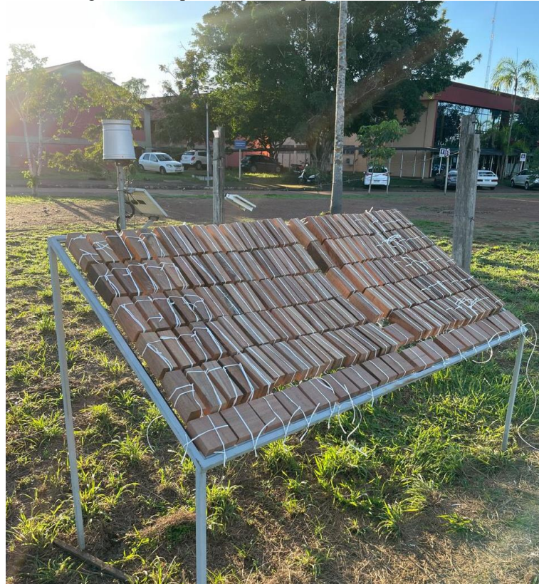
Figura 7 - Corpos de Prova expostos ao intemperismo
