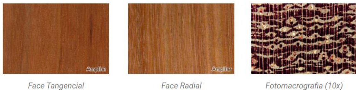
Figura 2 – Representação das seções tangencial e radial e fotomicrografia da madeira Angelim-Vermelho
