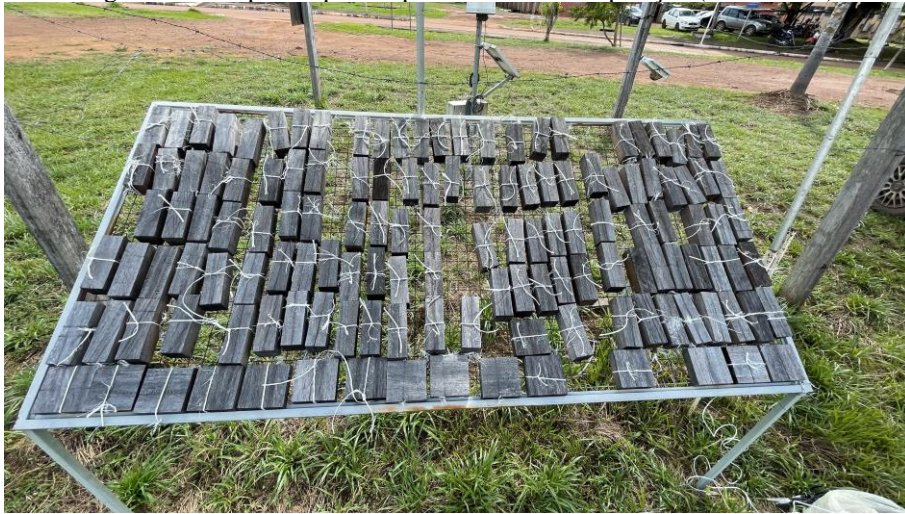
Figura 18 - Corpos de prova após 12 meses de exposição (25/04/2024)
