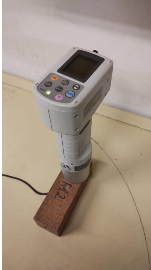
Figura 12 - Ensaio de Colorimetria utilizando colorímetro portátil do tipo Konica Minolta CR-400
