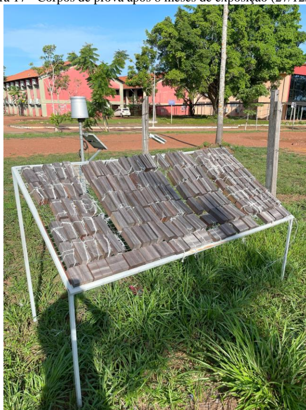
Figura 17 - Corpos de prova após 8 meses de exposição (27/12/2023)
