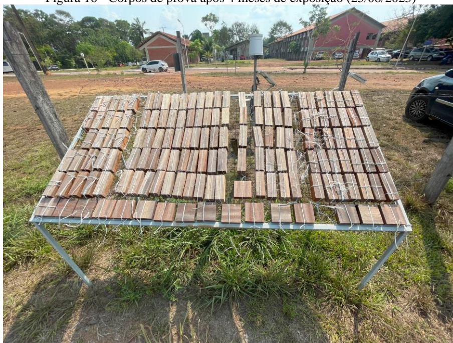
Figura 16 - Corpos de prova após 4 meses de exposição (25/08/2023)
