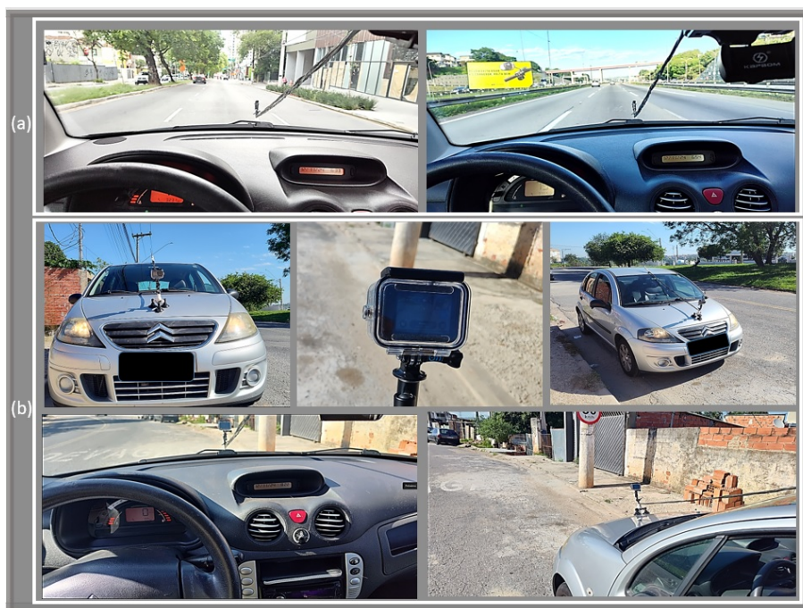
Figura 55 – Verificação de estabilidade e instalação da caixa estanque e da câmera de ação Fonte: Elaborado pelo autor
