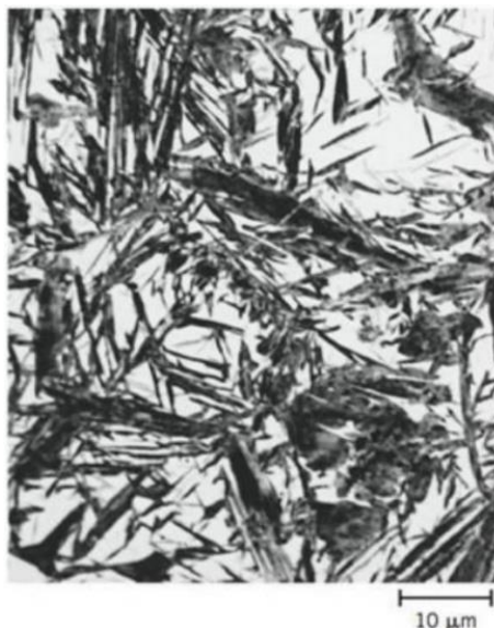
Figura 2.1 – Micrografia representativa da microestrutura martensítica de alta liga ou acicular [1].
