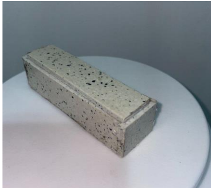
Figura 8. Amostra produzida para o cálculo de densidade.
