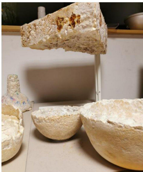
Figura 5: Compósitos fúngicos produzidos em moldes distintos. Retirado de Sydor, 2022.
