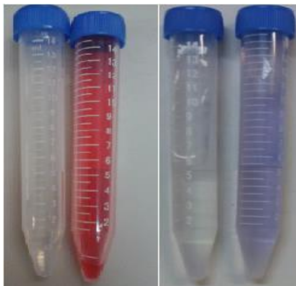
FIGURA 4.1.2.16 Da direita para esquerda temos a solução depois e antes da adsorção com MCM-41-NH 2 dos corantes vermelho de remazol e azul brilhante de remazol.
