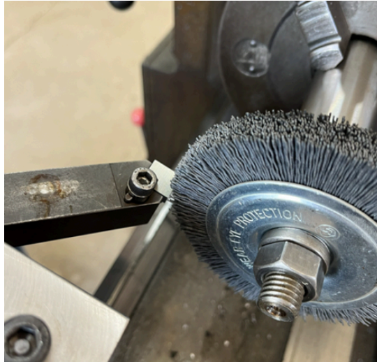
Figura 13 – Procedimento de arredondamento de aresta por escovamento.
