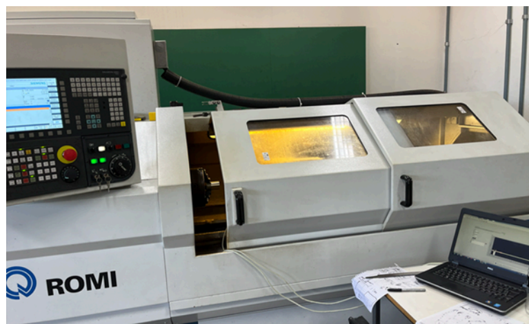
Figura 12 – Torno CNC para realização dos testes de usinagem.
