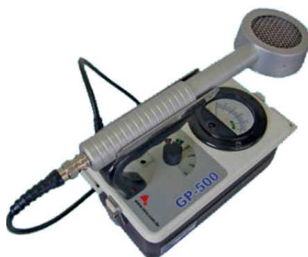
Figura 38 – Contador Geiger-Müller Pancake
