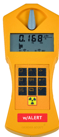
Figura 40 – Contador Geiger-Müller Digital
