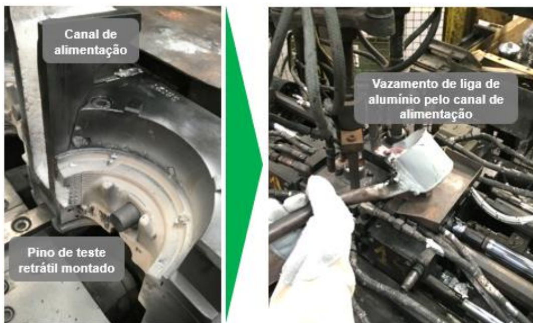
Figura 28 - Coquilha metálica (molde permanente) com a) pino montado na janela e b) vazamento de liga de alumínio pelo canal de alimentação
