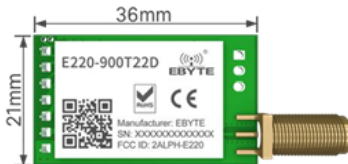
Figura 14 – Ilustração do módulo LoRa E220-900T22D - fonte: Manual de Usuário do módulo disponível pela Ebyte
