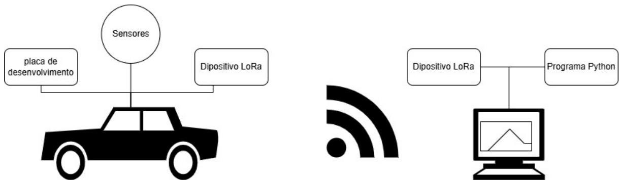
Figura 10 – Representação do Sistema de telemetria - fonte: O Autor
