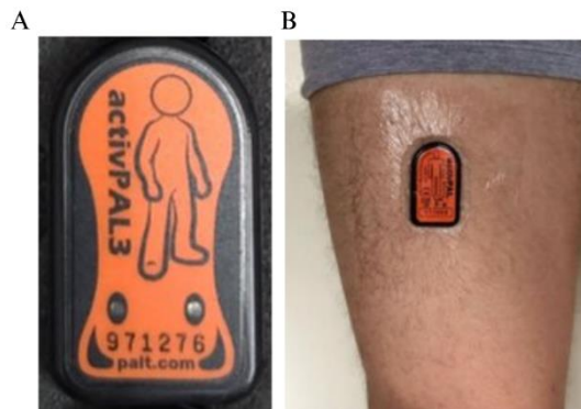
A: Acelerômetro activPAL3 micro; B: Acelerômetro fixado no terço médio da coxa por meio de um filme adesivo transparente Cremer Advanced.
