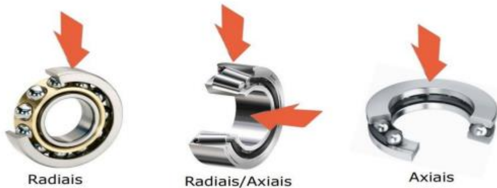
Figura 3 - Cargas aplicadas sobre os rolamentos
