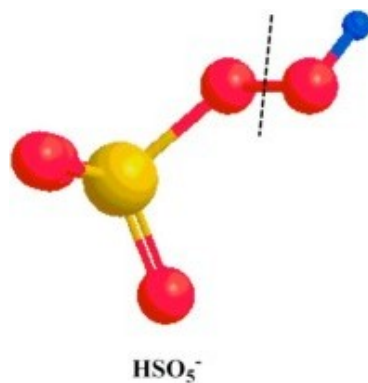
Figura 4 – Estrutura química do PMS. A cor amarela representa o átomo de enxofre e a vermelha, o átomo de oxigênio. A linha tracejada representa a posição de fissão da ligação simples O-O para a formação dos radicais sulfato. Fonte: Adaptado de Wang e Wang (2018).
