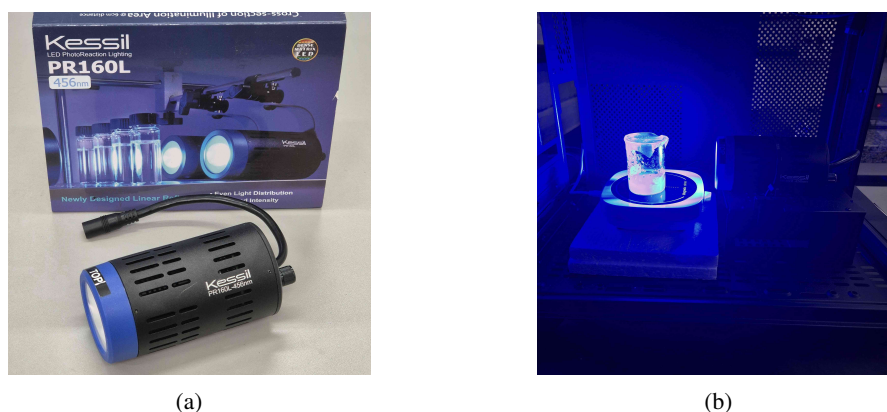
Figura 13 – Equipamentos utilizados para degradação das soluções de ácido cafeico: a) Lâmpada fonte de radiação visível (VIS): Kessil LED PhotoReaction Lighting modelo PR160L - 456 nm; b) Dispositivo completo utilizado para aplicação de radiação VIS. Fonte: Autoria própria.
