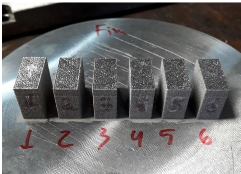
Figura 3.7 – A imagem superior exibe as dimensões das amostras impressas com os parâmetros ótimos juntamente com a estratégia de varredura empregada neste estudo, que consiste em faixas de 5 mm de largura com movimento unidirecional do laser. A espessura da camada foi definida em 30 micrômetros e, para cada camada subsequente, o padrão rotaciona 32 graus para a direita. A imagem abaixo exibe amostras reais produzidas com os parâmetros ótimos encontrados.
