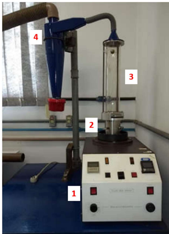
Figura 6 - Leito de bancada do Departamento de Engenharia Química UFSCar utilizado como referência para simulação.
