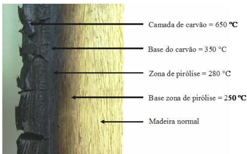
Figura 2.5: Distribuição típica das zonas térmicas na madeira durante a carbonização
