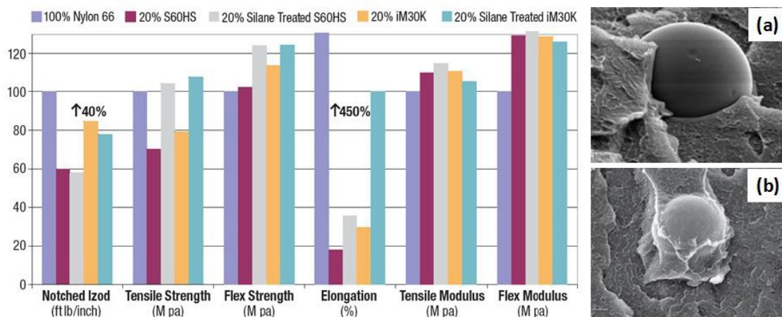
Figura 3.12 - Propriedades mecânicas de compósitos de PA66/MEVO e micrografias de MEV de microesferas (a) sem e (b) com tratamento superficial aminosilano [36].
