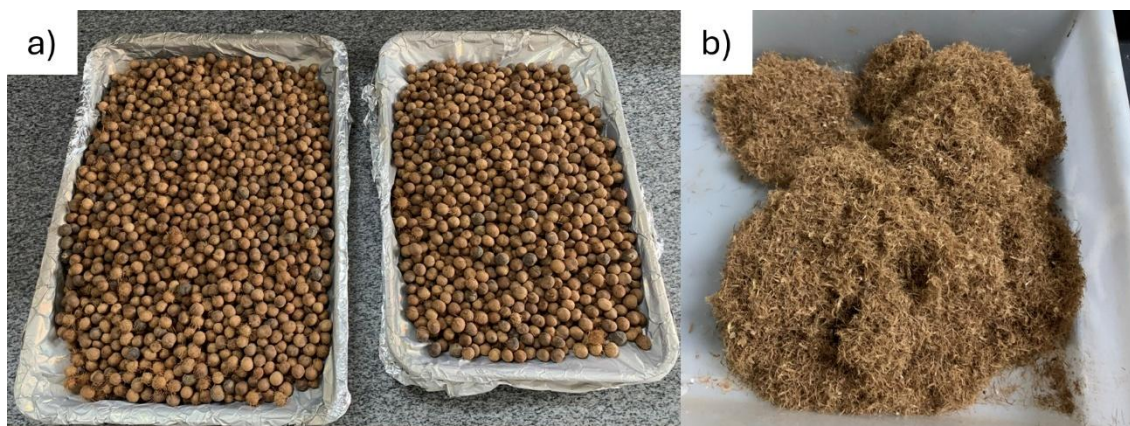
Figura 3.3: resíduo de açaí antes (a) e após (b) o processo de moagem.
