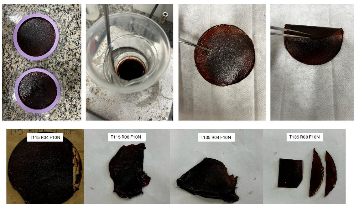
Figura 4.24: filmes de biocompósitos produzidos em placas de silicone com a utilização de resíduo de açai não modificado.
