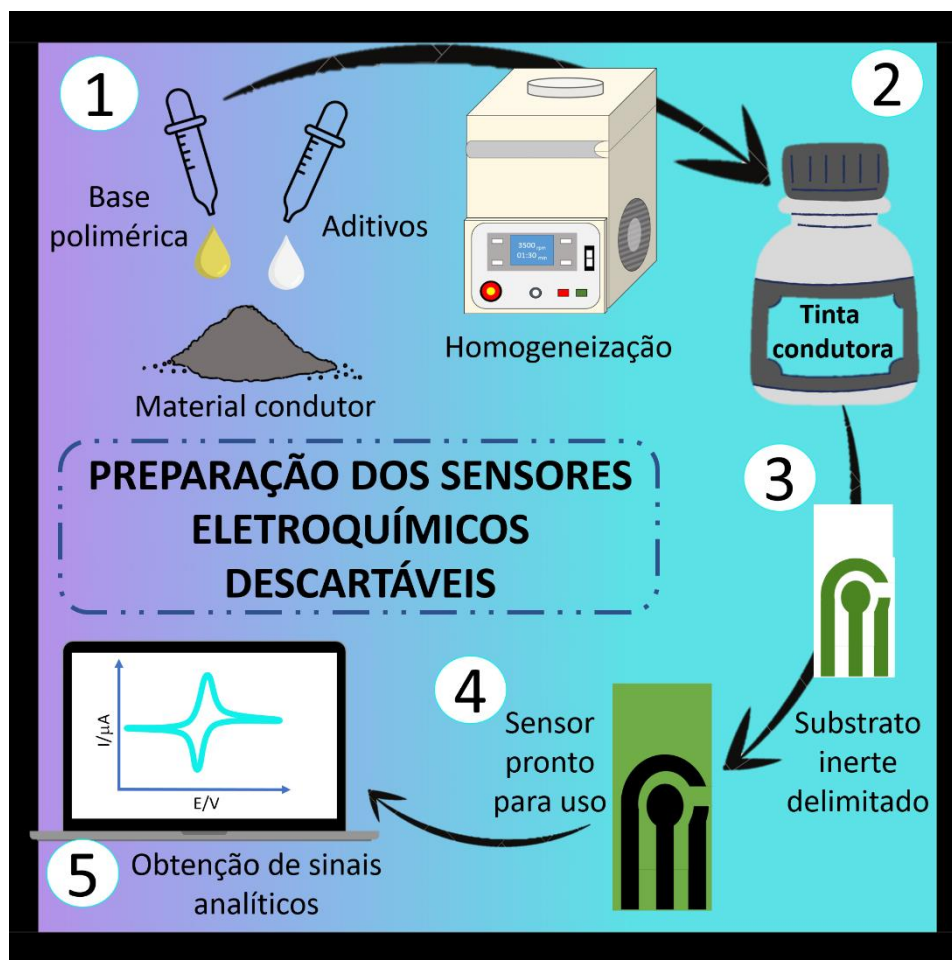
Figura 1. Esquemática do preparo do sensor CGG/PET. (passo 1) A solução de quitosana, o grafite e o glicerol foram misturados; (passo 2) A tinta foi agitada por 270s a 3500 rotações por minuto; (passo 3) O substrato foi preparado e um delimitador adesivo sobre o mesmo; (passo 4) A tinta foi espalhada o delimitador foi removido, e posterior tempo de secagem na estufa, o sensor está pronto para utilização na obtenção de sinais analíticos (passo 5)
